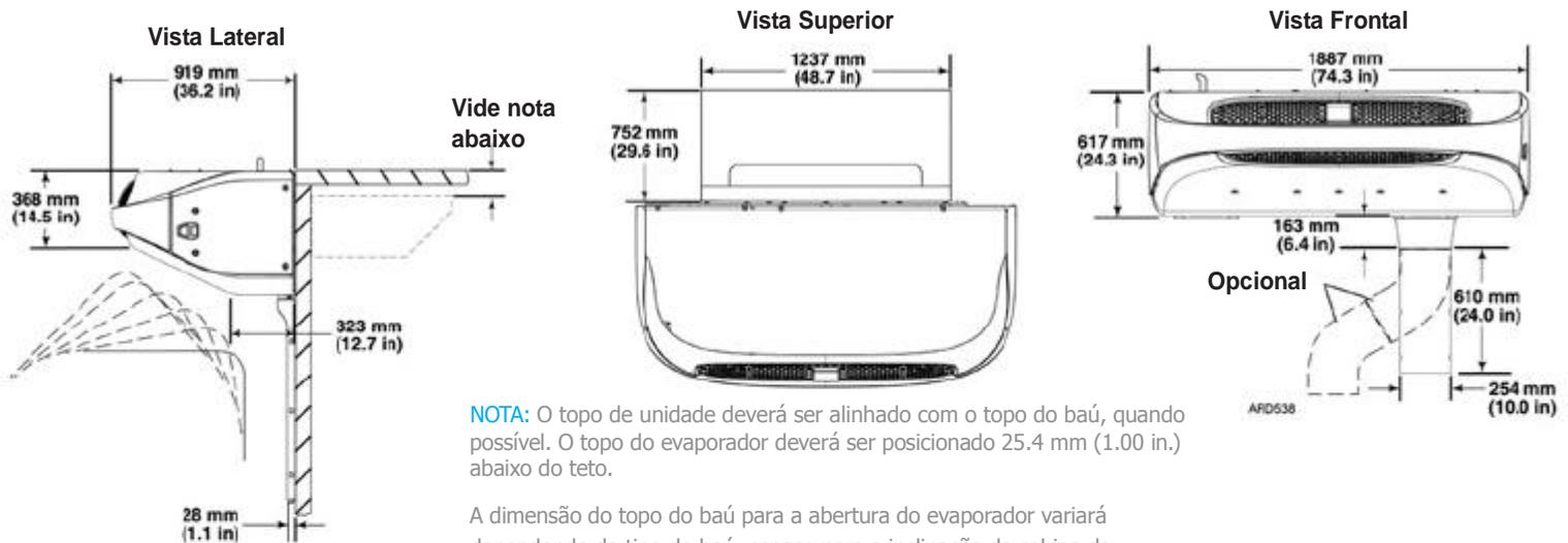
**NOTA:** O topo de unidade deverá ser alinhado com o topo do baú, quando possível. O topo do evaporador deverá ser posicionado 25.4 mm (1.00 in.) abaixo do teto.
